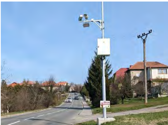
Úsekové měření Salaš
