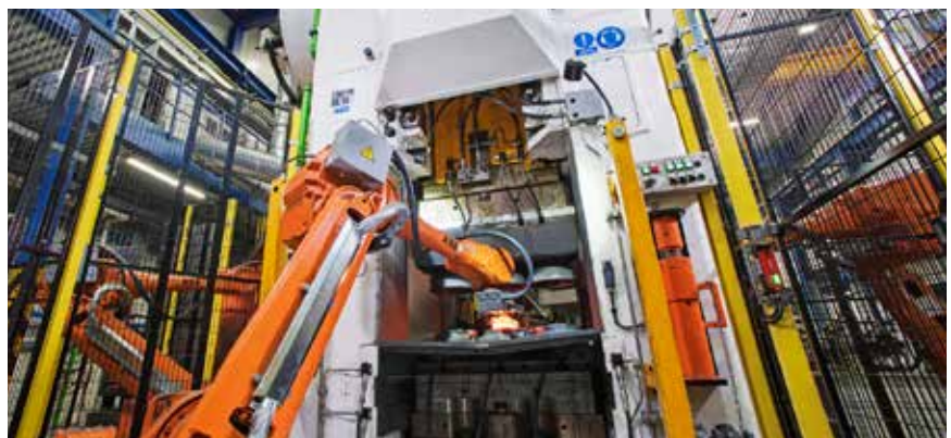
Plně robotizovaná kovací linka
