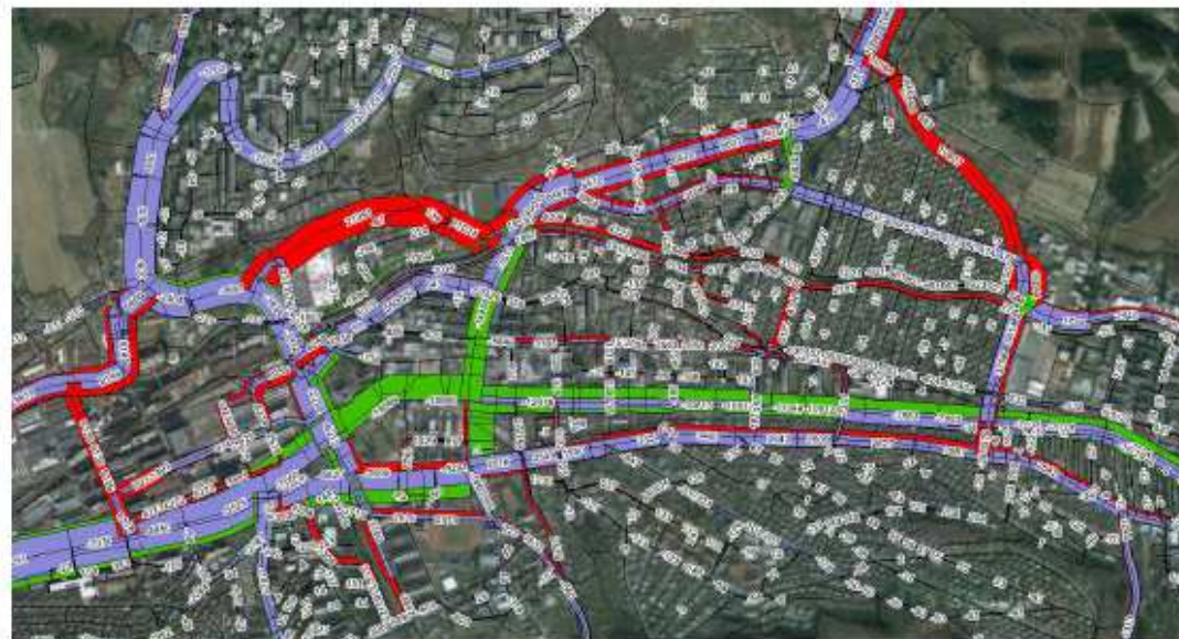
Obrázek 27: Rozdíl intenzit provozu za 24 hodin oproti stavu
