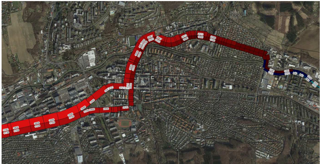
Obrázek 61: Kartogram dopravního zatížení trolejbusové linky číslo 2 v osobách za 24 hodin, detail centra města
