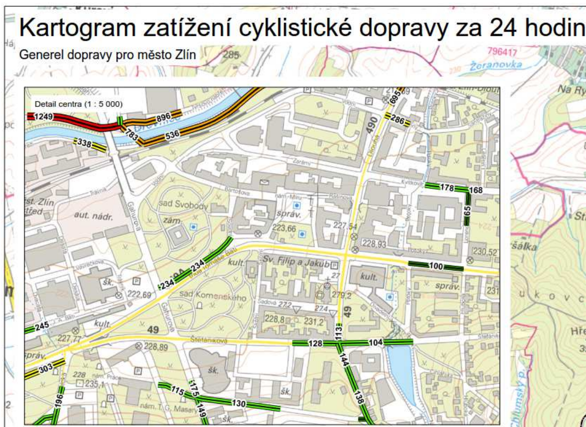
Obrázek 78: Kartogram zatížení cyklistické dopravy za 24 hodin, detail centra města, data z dopravního průzkumu
