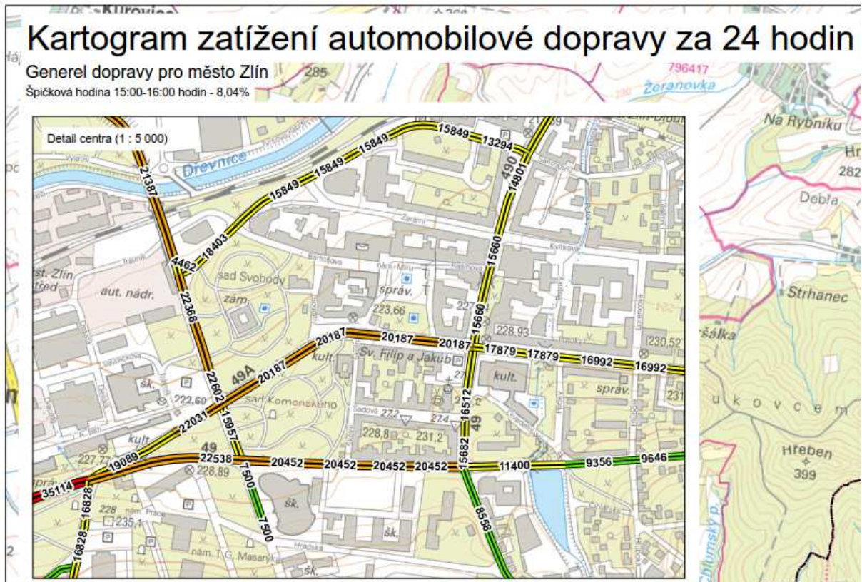
Obrázek 35: Kartogram dopravního zatížení komunikací v centru města ve vozidlech za 24 hodin
