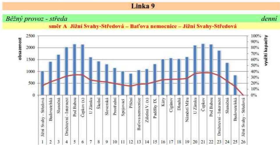
Graf 63: Průběh dopravního zatížení a využití nabídky na trolejbusové lince číslo 9, data z dokumentace
