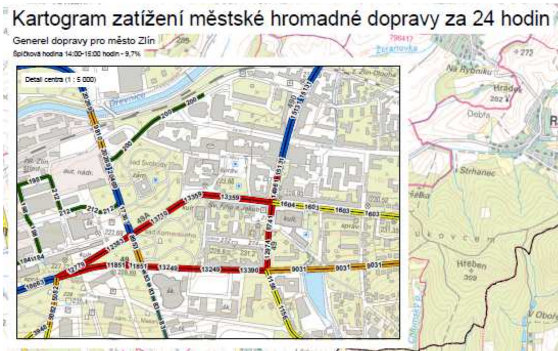
Obrázek 60: Kartogram dopravního zatížení sítě MHD v osobách za 24 hodin, detail centra města
