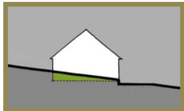
ČÁSTEČNÉ ZAHLOUBENÍ PŘÍZEMÍ
